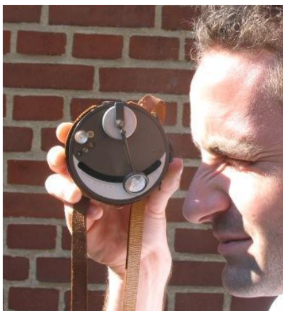
Figur 7. Der sigtes gennem kikkerten og alhidaden drejes med den skrue der sidder foroven på billedet.
