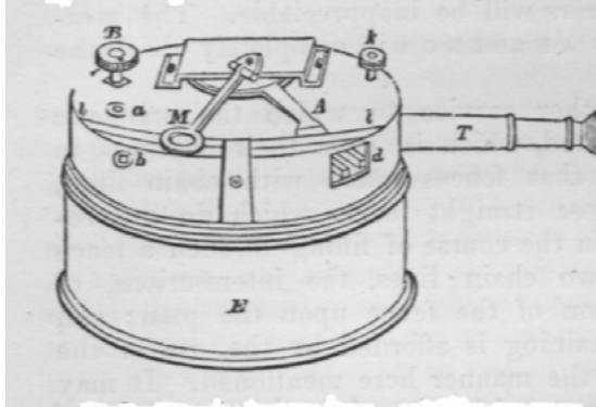
Følgende foto viser en bokssekstant fabrikeret formentlig i anden halvdel af 1800-tallet (Gowland, Liverpool). Fotoet til venstre viser sekstanten i sammenpakket tilstand, og fotoet til højre viser instrumentet med låget skruet på som håndtag. Man ser også kikkerten trukket ud af sit hul. Den fjerneste skrue er til at bevæge alhidaden med, mens den forreste skal bruges til justering af horisontspejlet.
