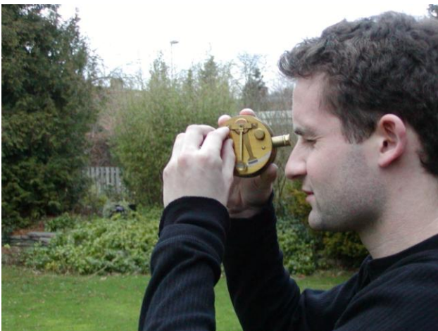
Figur 8. Der sigtes gennem kikkerten og alhidaden drejes med den skrue der er længst væk, som det ses på billedet.
